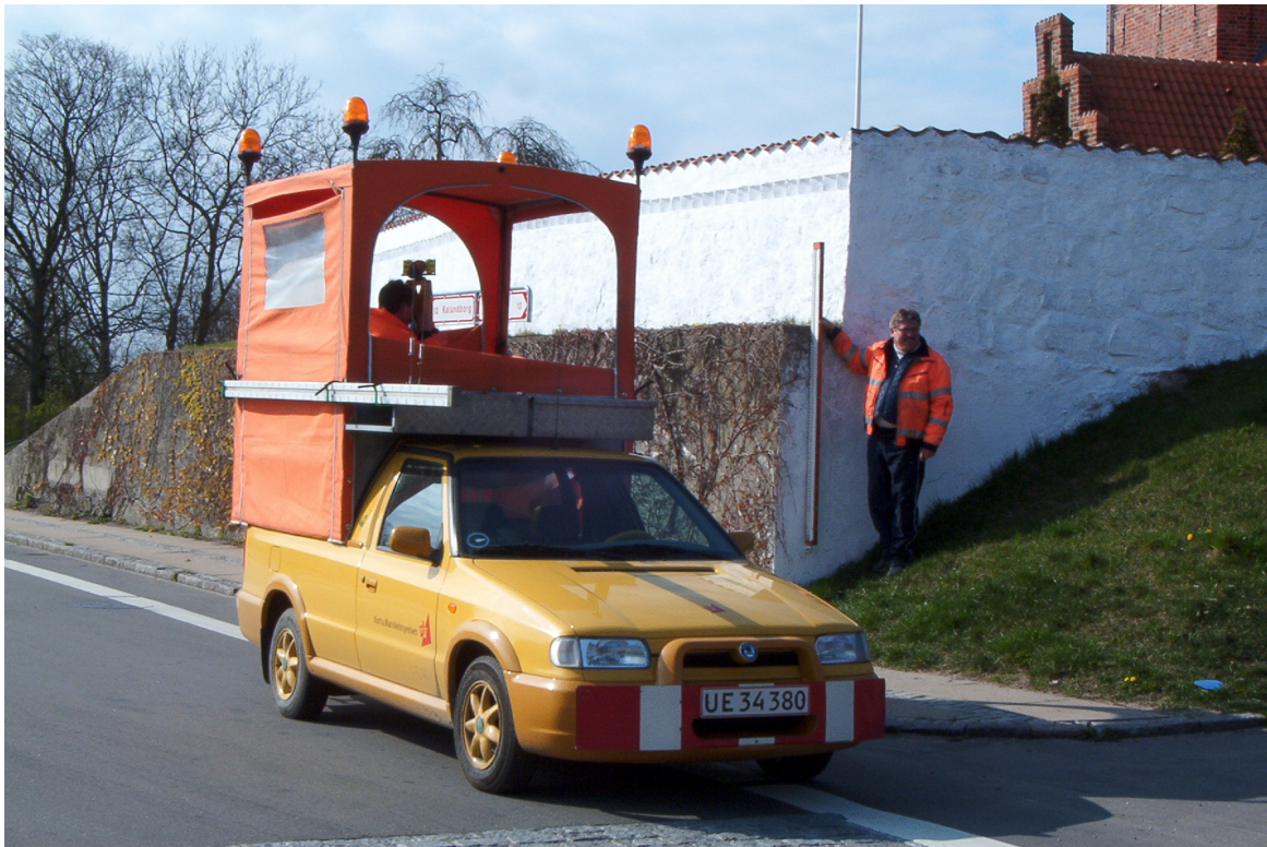
Figur 8: Øverst: Motoriseret nivellement under udførelse. Nederst: måling til fikspunkt.
