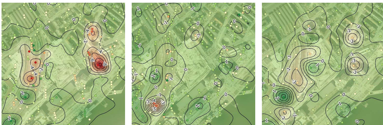
Figur 1. Vertikalbevægelser beregnet ud fra korrigerede og kalibrerede Sentinel-1 LOS-beregninger for ascending track LOS-146A (øverst). Vertikalbevægelser beregnet ud fra korrigerede og kalibrerede LOS-beregninger for Sentinel-1 descending track LOS-66D (Midt). Vertikalbevægelser præsenteret i form af 2D vertikalproduktet (nederst).
