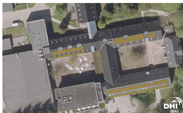
Deep learning-tilgang til automatisk segmentering af solceller på tage, fra høj opløsnings-satellitbilleder.
