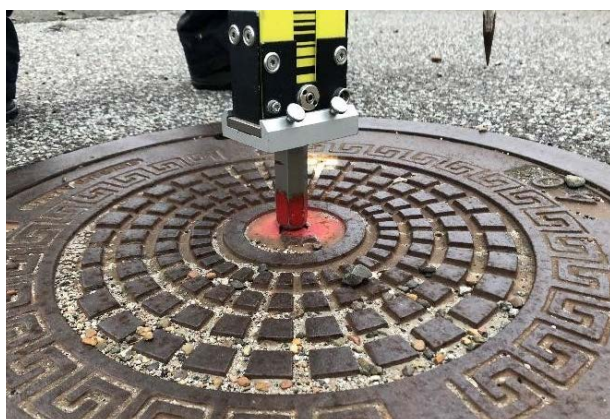
Figur 1. Stadie med adapter på midten af brønddækslet, som er defineret som "målepunktet" på alle dæksler.
